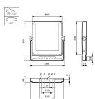
**Scheda tecnica Philips Proiettore LED Coreline BVP140 Aluminium 225W 31500lm 73x26D - 740 Bianco Freddo | IP66 - Simmetrico**
