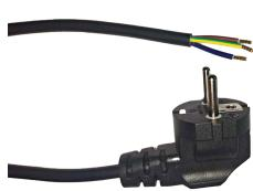
Scheda tecnica Noxion Power Cavo di alimentazione Nero - Shuko Europlug + Estremità aperte - 2m - 3 pole 0,75mm<sup>2</sup>
